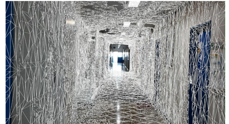
SLAMによって構内をマッピングした様子
