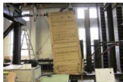
(a)L09-3 破壊時変形
